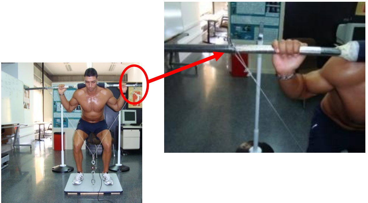
Figura 15. Dispositivo diseñado para la realización de una tracción equilibrada durante el ejercicio de la sentadilla.
